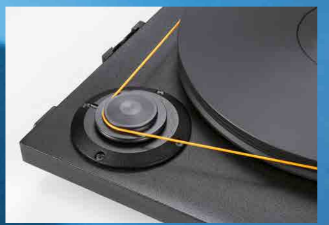
▲ Der Motor hat nur eine Drehzahl. Für 45 Touren muss der Riemen auf die größere untere Scheibe des Pulleys umgelegt werden.
