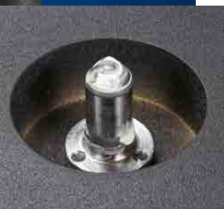
Das Inverslager des Plattentellers hält den Schwerpunkt tief und wird über ein Gleitgel geschmiert. ▶
