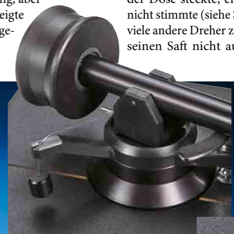
◀ Die Antiskating des Tonarms erfolgt auf ganz klassische Weise per Gewicht an der Angelsehne.
