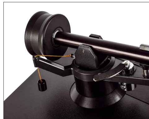
Das Antiskating wird nach alter Väter Sitte mit Umlenkrolle, Faden und Gewicht realisiert
